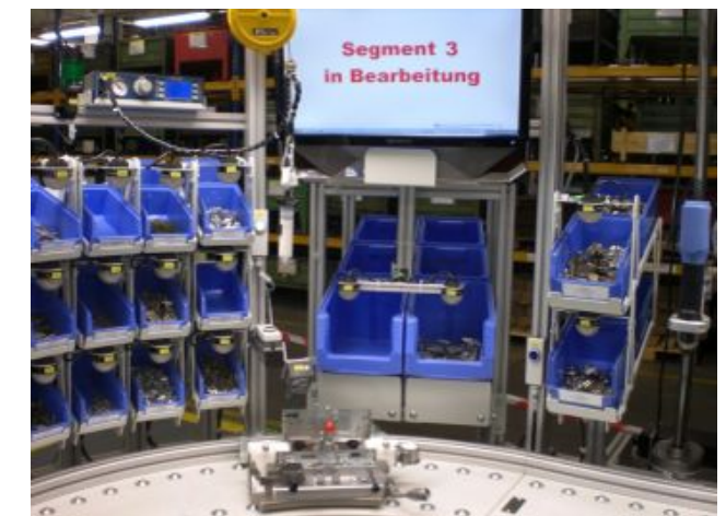
Werkstückträger an Segment-Stoppstelle mit Monitor für Montagehinweise
