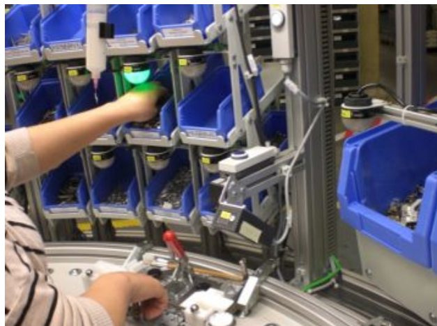
Das grüne Licht signalisiert das nächste Bauteil, das auf dem Werkstückträger montiert oder mitgeführt werden soll.
